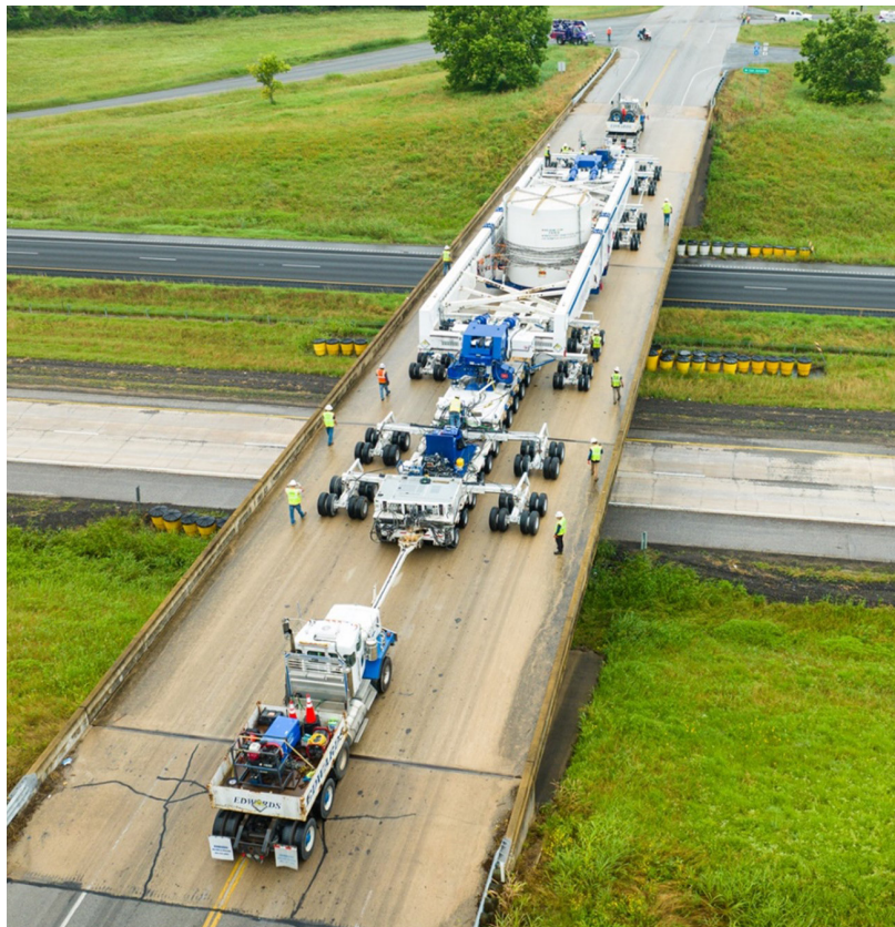
反應器容器透過公路運送緩慢地越過橋樑（圖片來源：Orano 公司官網）
