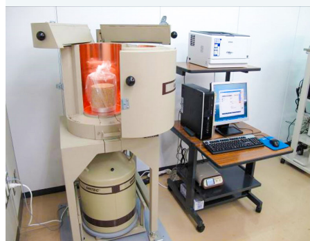
圖一 高純銻偵檢器使用於加馬多頻道能譜分析系統
