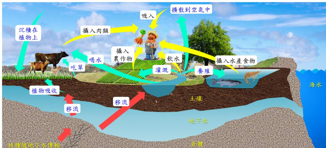
圖 5.2.2-1 陸域生活型態之生物圈核種傳輸示意
