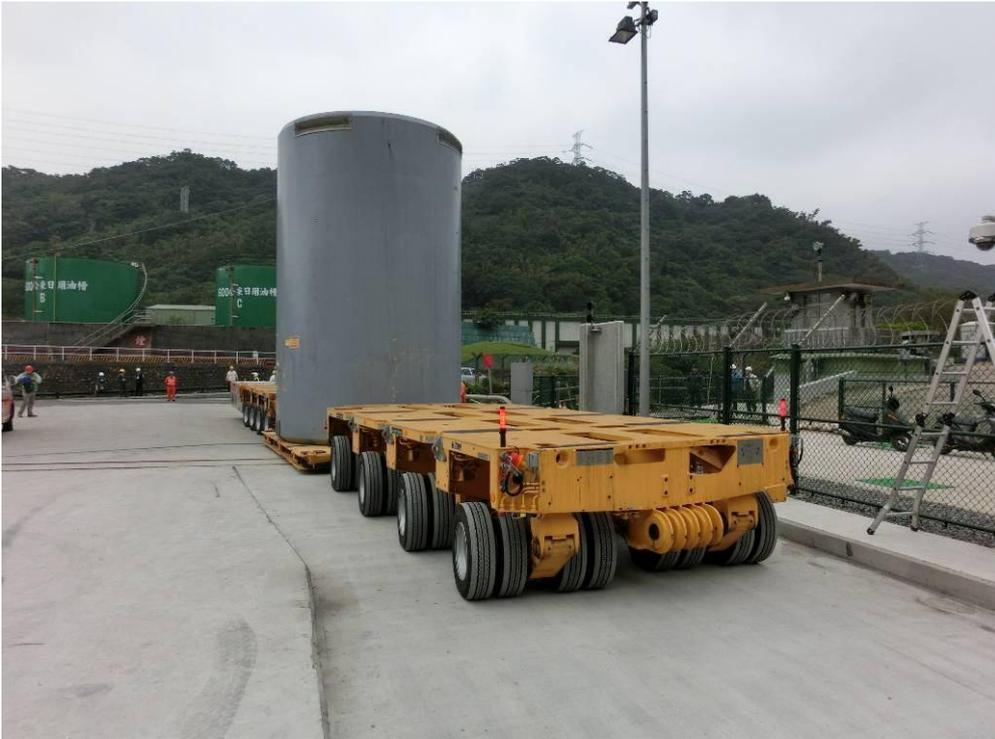
圖 6 多軸油壓板車駛離貯存場
