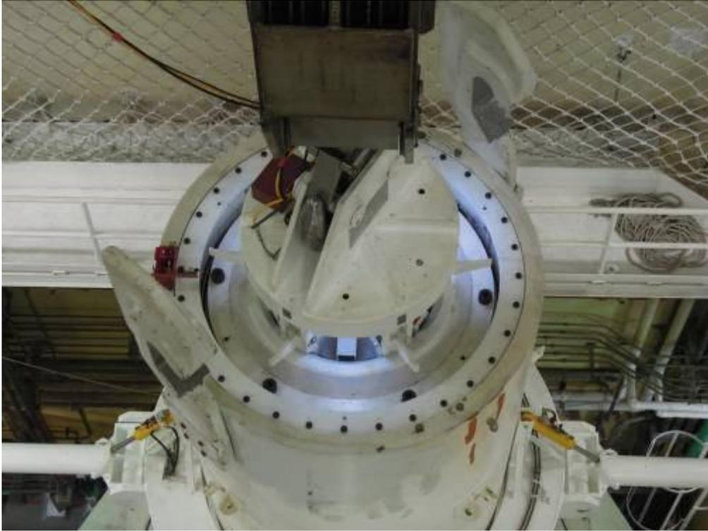
圖 18 將密封鋼筒吊入傳送護箱內
