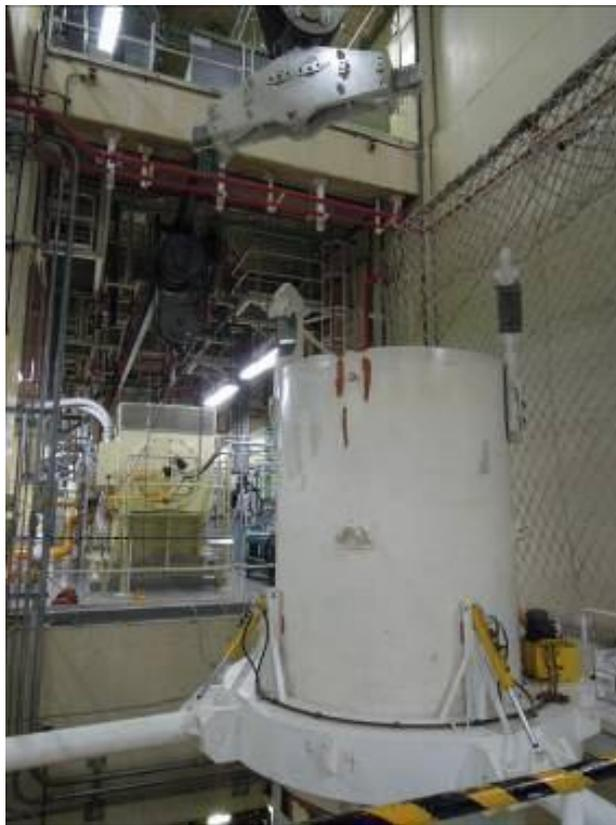
圖 19 準備以吊軌將傳送護箱吊至 5 樓
