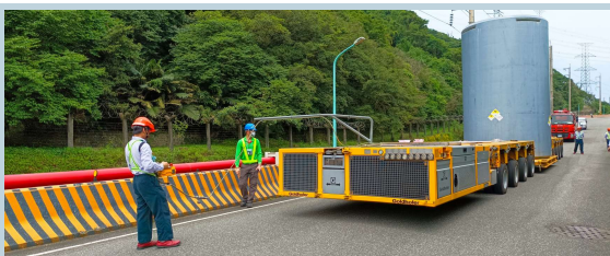
混凝土護箱 (VCC) 藉由多軸油壓板車廠內運送作業
