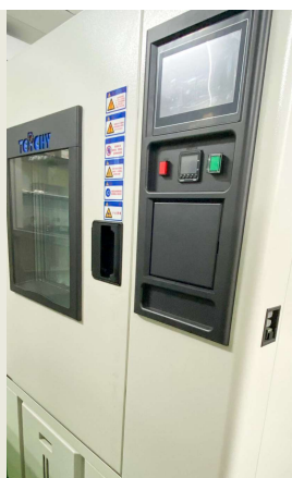
更新後：恆溫濕度控制機
