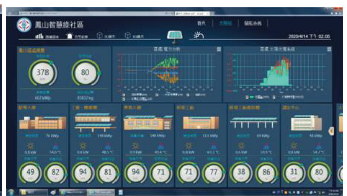
圖 5 鳳山區處太陽光電發電紀錄及電力分析
