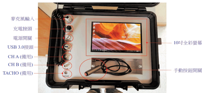
圖 2 葉片狀態巡檢裝置(主體)
