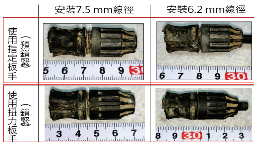
圖 7 預鎖緊與完整施工之間隙比較
