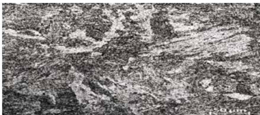
圖 2 HP 1st 底座出氣側側面潛變取樣金相
