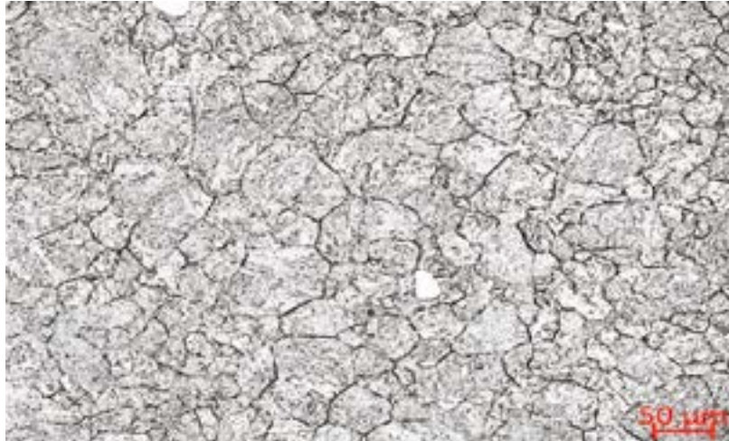
圖 1 IP 3rd 底座出氣側側面回火脆化取樣金相
