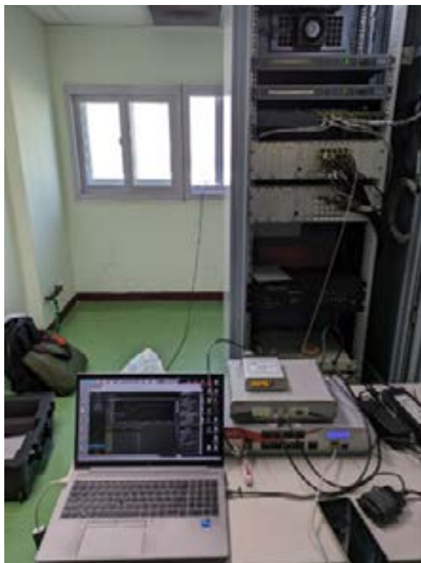
圖 1 現場量測儀器時間同步測試儀配置
