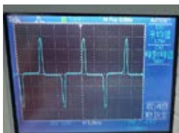
比流器開路電壓量測
