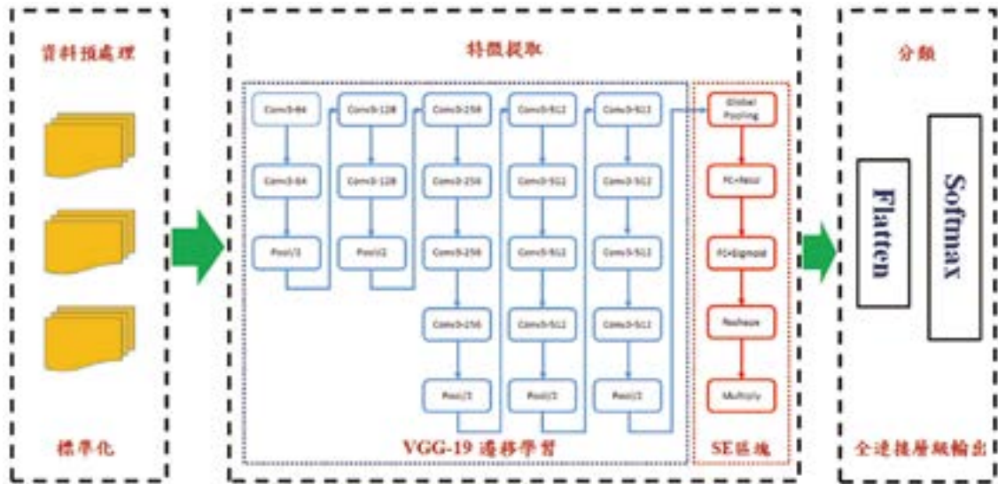
圖 1 VGG-19-SENet 鍋爐鋼材金相鑑別模型架構
