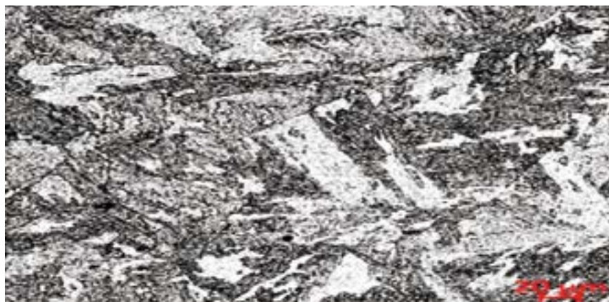
圖 2 IP 1st 底座出氣側潛變取樣金相
