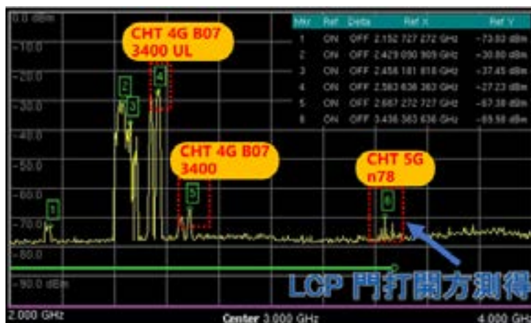
圖 2 頻率範圍 2~4 GHz 於機組 LCP 內之量測結果
