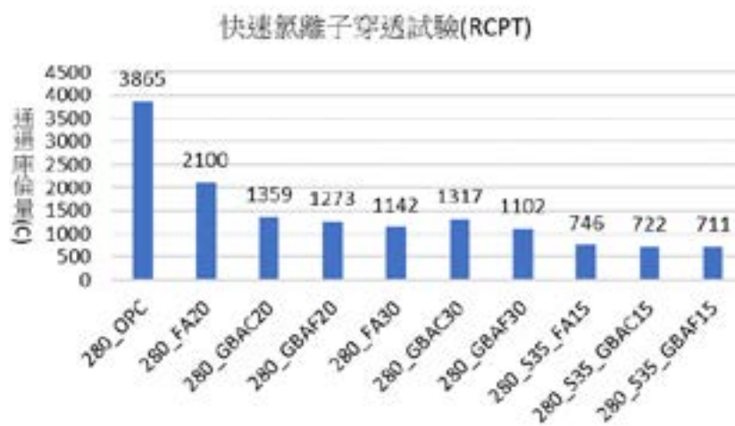
圖 4 混凝土耐久性試驗 (RCPT，強度 280 kgf/cm 2 ，齡期 56 天)
