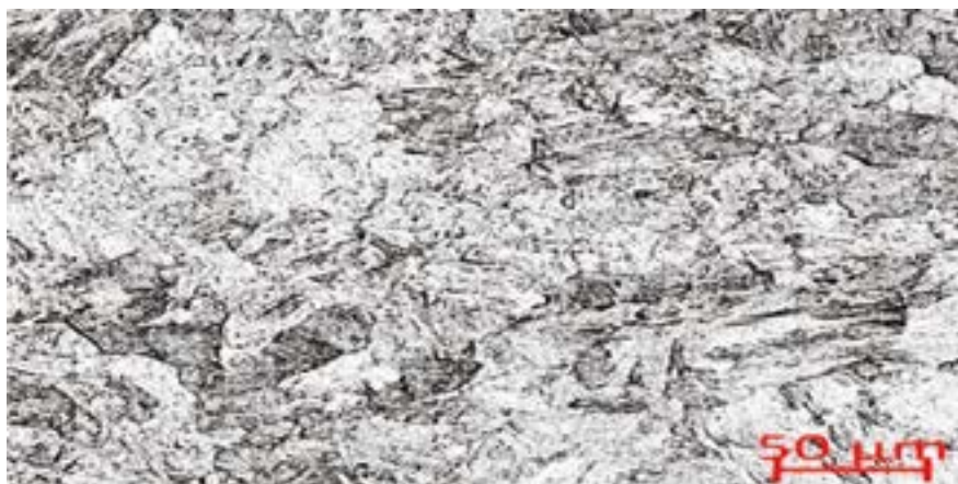
圖 1 IP 1st 底座出氣側回火脆化取樣金相
