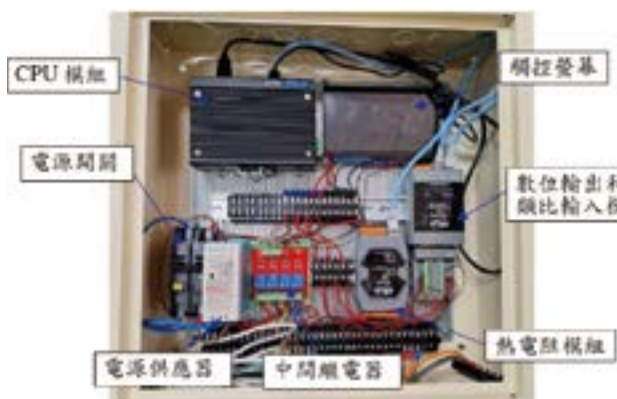
圖 1 新型控制器的照片和硬體規格
