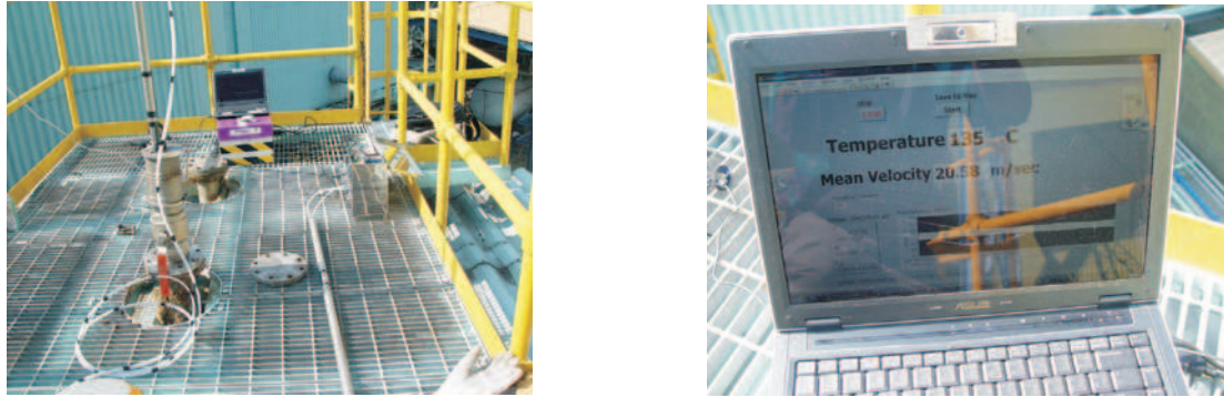
圖 1 自行開發設計之煙道煙氣流場及管道振動即時偵測系統
