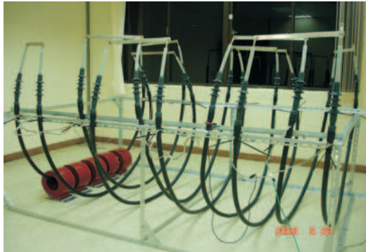
圖 1 加速老化壽命試驗實體圖
