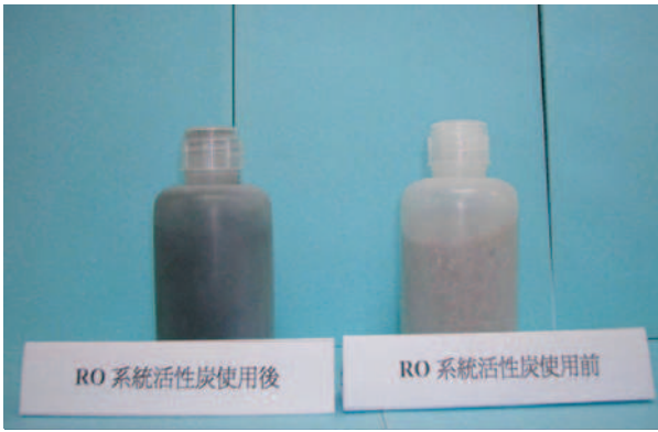
圖 7 RO 系統離子交換樹脂使用比較前(右)、後(左)
