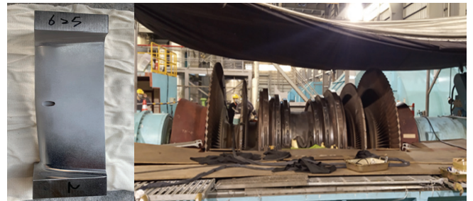
圖 3 (左)試銲之模擬試片;(右)準備進行施銲之低壓汽渦輪機轉子
