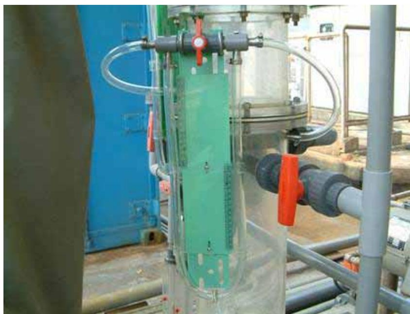
圖2. 量測多孔板前後氣體壓差變化
