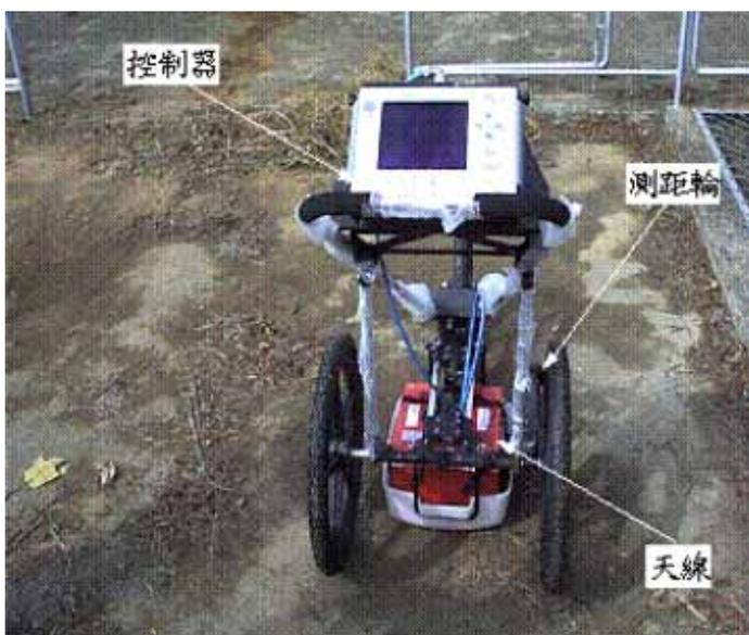
圖1. 透地雷達系統圖示
