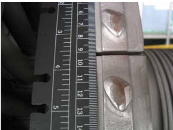
圖1. 一號機高壓轉子第9級動葉榫頭照片
