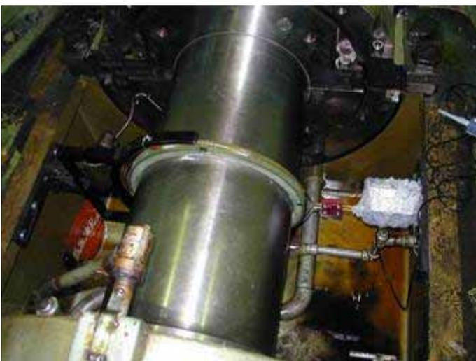
圖1. 扭轉振動訊號無線發報量測系統
