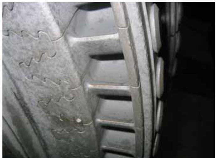
圖2. 三號機高壓轉子衝擊段動葉沉積物照片
