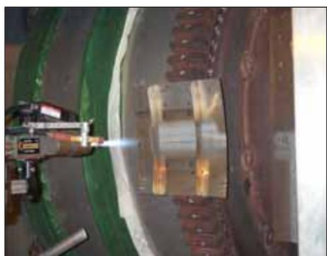
圖 1. GE 氣渦輪機葉輪噴鋁情形
