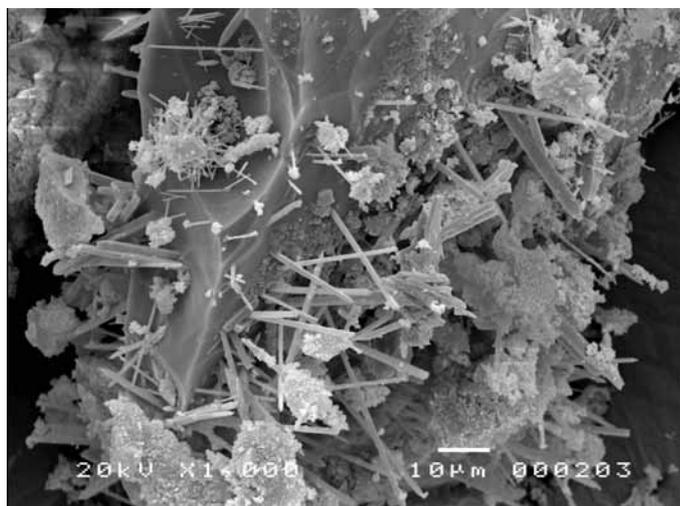
圖1. 一般硬質渣經HF酸處理過後之形貌
