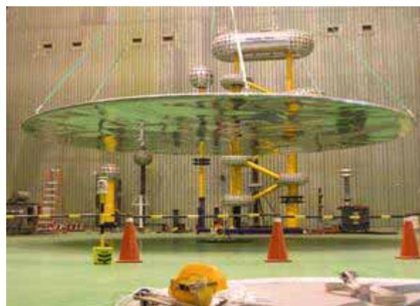
圖2、消雷針試驗之照片
