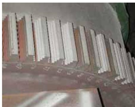
圖 2. GE 氣渦輪機葉輪噴鋁後照片
