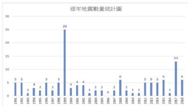
圖 2 彰濱工業區二氧化碳試驗灌注場址附近 20km 範圍內逐年地震數量統計圖，縱軸單位為地震數量，橫軸單位為地震發生年份。
