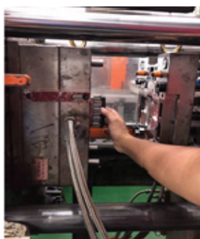
圖 3 複合材料膠粒經射出成形機(左)
