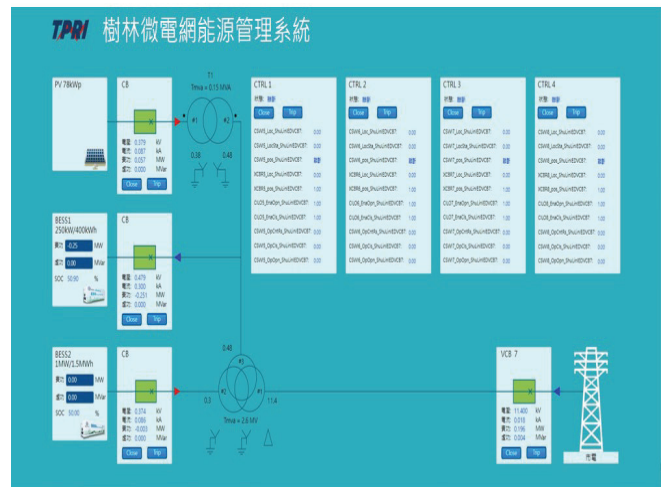
圖 4 微電網控制系統(MGCS)人機介面
