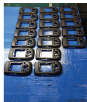
圖 4 製造導航機外殼產品(右)
