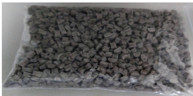
圖 2 廢棄濾袋解鏈後粒料添加 40% 玻璃纖維並透過雙螺桿押出混煉所得複合材料膠粒
