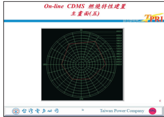
圖 3 氣渦輪機排氣溫度影響分析圖
