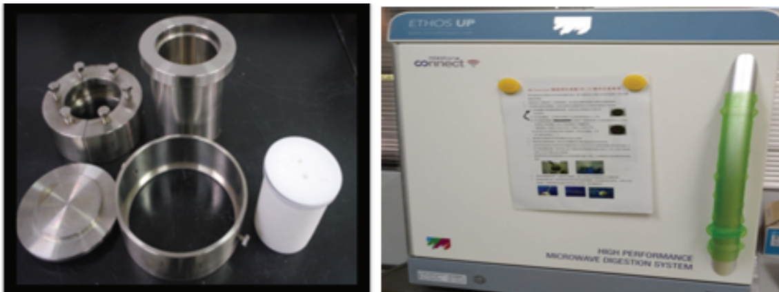
圖 1 左：水熱釜系統；右：微波系統
