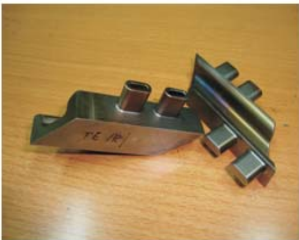
圖 2 低壓汽機末級動葉片之 Cover Segment
