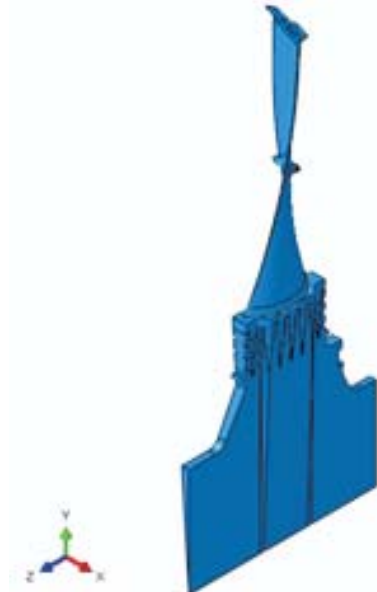
圖 3 低壓汽機末級動葉片 1/94 實體模型
