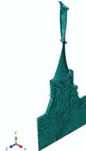
圖 4 低壓汽機末級動葉片、軸碟及轉軸網格模型
