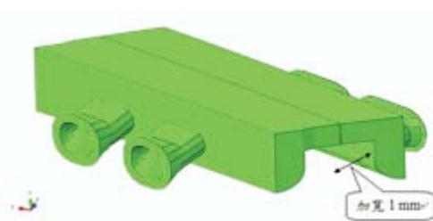
圖 9 模型 5：將 Cover Segment 寬度
