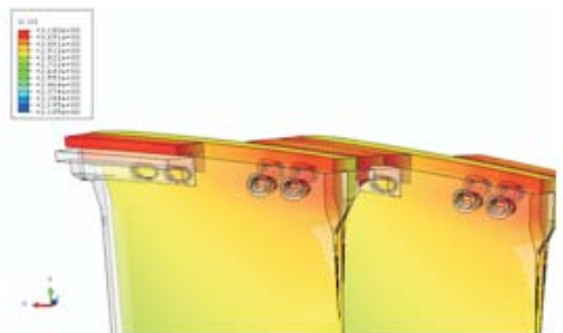
圖 5 模型 2 Cover Segment 受旋轉離心力
