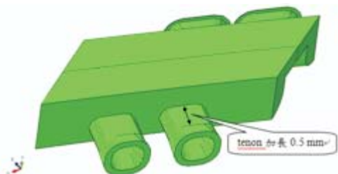
圖 7 模型 3：空心 tenon 加長 0.5mm
