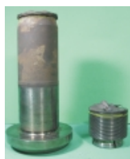
圖 1 斷裂之 ID Fan 主軸
