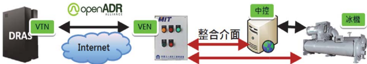
圖1 空調自動需量反應系統架構示意圖
