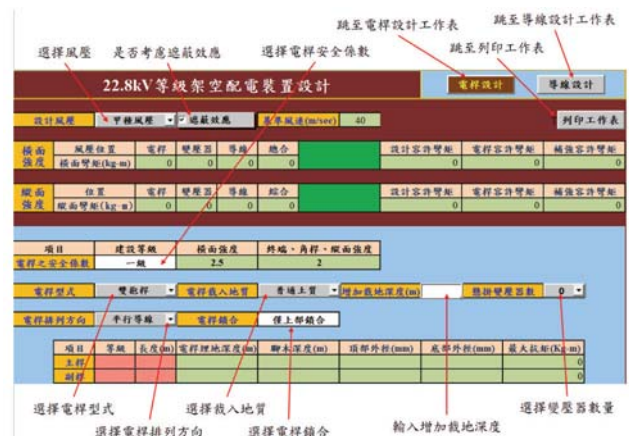
圖 4 22.8kV 架空配電裝置設計程式
