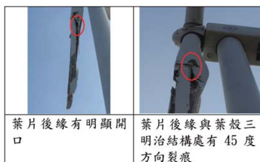
圖 1 葉殼與抗剪腹板黏結處破壞
