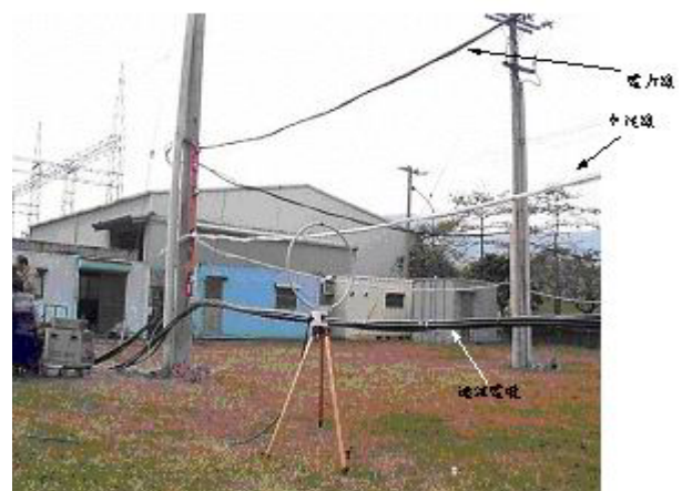
小型通訊測試系統實驗架構圖
