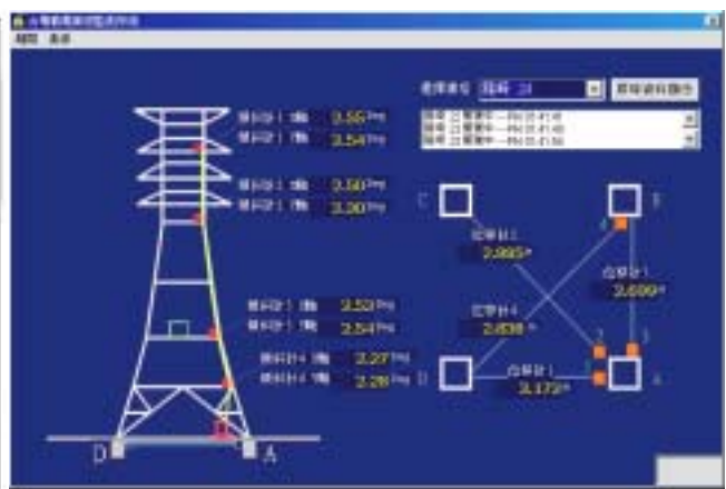
圖二、監測系統主機即時程式所呈現之監測畫面
