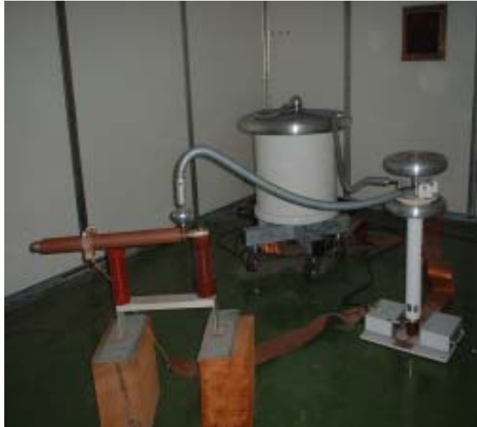
圖一、4.16KV斷路器套管之部份放電試驗
