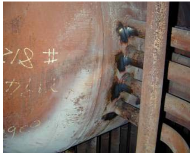
圖二、集管與歧管焊道熱影響區複製膜取樣
