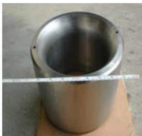
圖二 閥座實體件經雷射包覆製程處理及加工完成後之外觀照片
