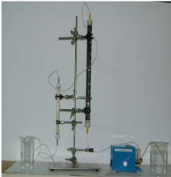
圖一、樹脂處理 FGD 廢水 COD 之設備及流程
