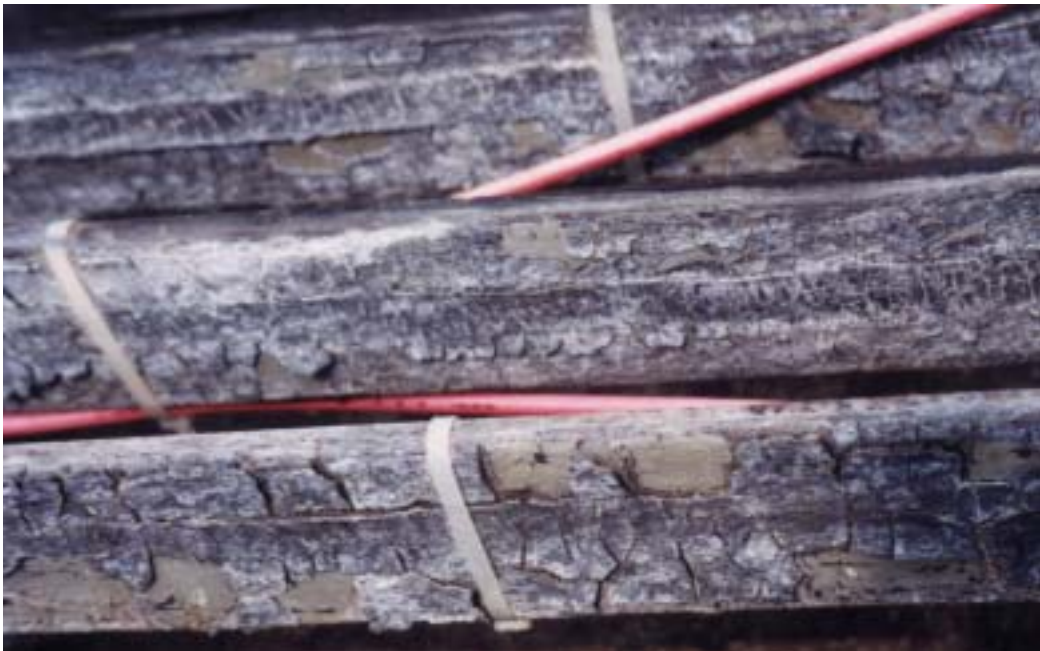
圖二 經過 8 個月現場試驗後導電塗料表面外觀。
