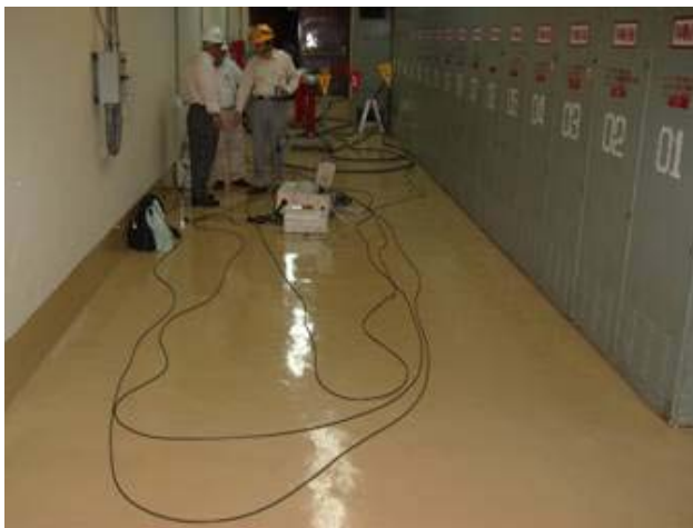
圖一、緊要匯流排突波試驗
