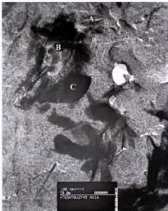
圖一 興達 No.3 號機高中壓轉子內孔 GN2745mm 取樣複製膜之 STEM 金相組織照片
