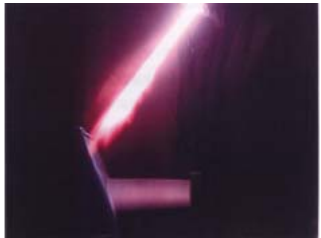
圖二、葉片在真空艙內實際噴鋅之情形
