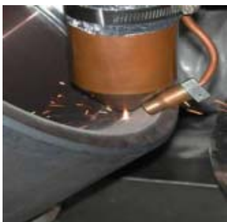
圖一 閥座實體件以雷射共軸包覆噴嘴進行閥座密封面包覆情形外觀照片
