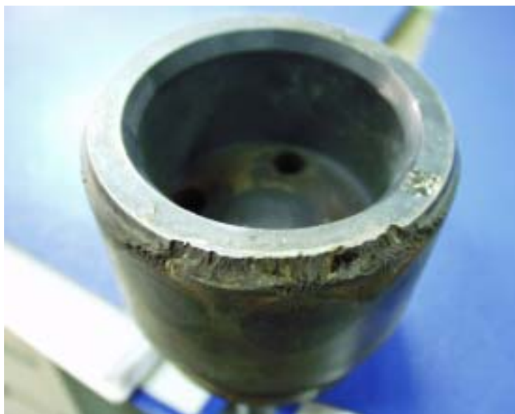
圖 1 閘塞於與閘座閉合部位受沖穴蝕情形 (使用約 12 月)
