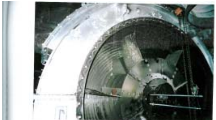
圖一、無肋條設計之排煤扇扇葉鉸及旋轉架 圖二、88.5.4發生在#2D台之扇葉鉸裂斷故障
