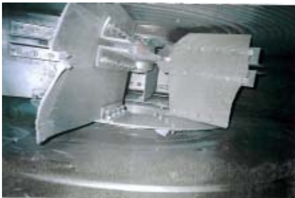
圖一、無肋條設計之排煤扇扇葉鉸及旋轉架 圖二、88.5.4發生在#2D台之扇葉鉸裂斷故障
