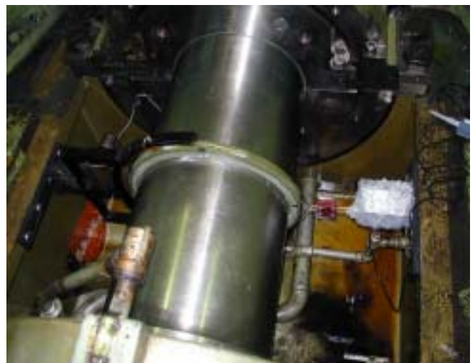
圖二、台中電廠#5機之扭振測試
