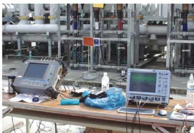
圖(1) 電纜系統線上PD檢測-高頻電流法
