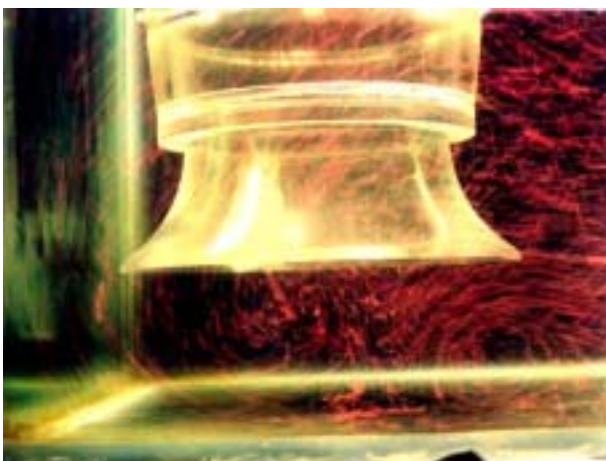
圖一、鐘形吸入口附近產生吸附於側壁之水下渦流
