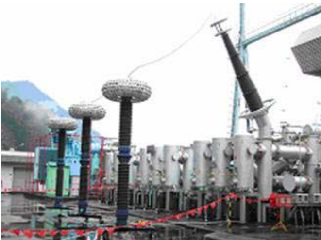
圖一、在線狀態GIS A相VFTO波形量測架構
