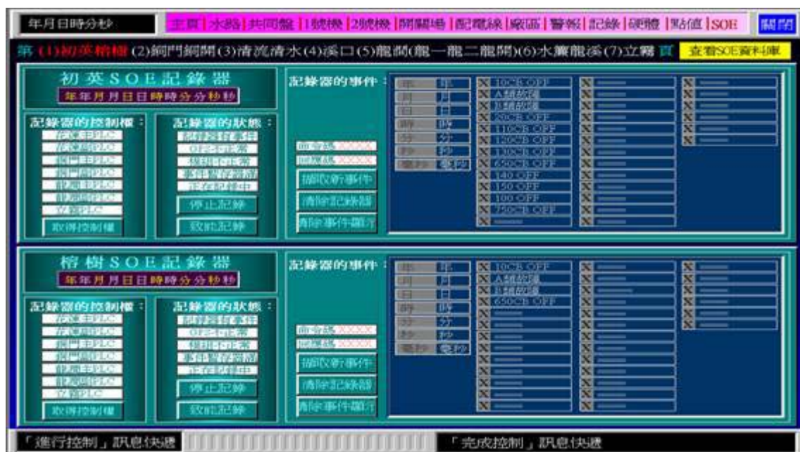
初英及榕樹電廠SOE記錄器事故資料擷取介面
