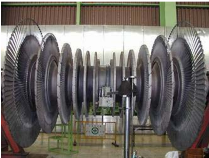
圖一、台中電廠#5機LP1轉子之模態測試
