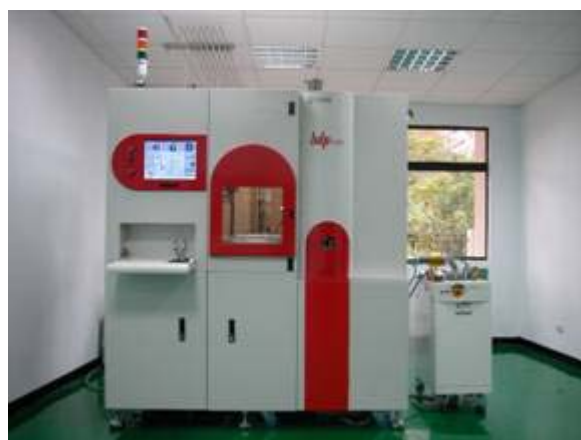
圖一、奈米碳管製程研究—高密度電漿化學氣相沉積儀（hdpCVD）
