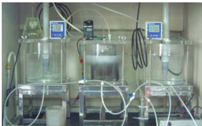
圖二、氫氧化鈉製備電解槽的建構圖示。
