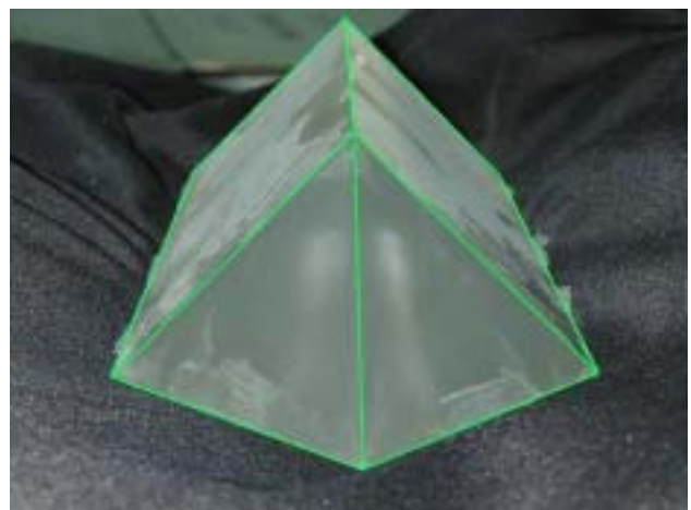
圖二、改善流道分隔板 (Splitter) 模型
