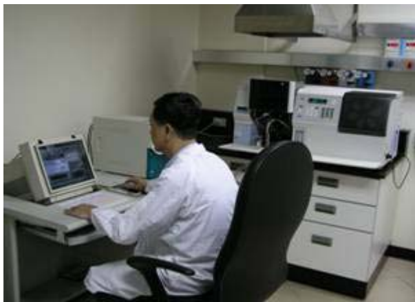
圖一、用原子吸收光譜儀測TCLP溶出成份
