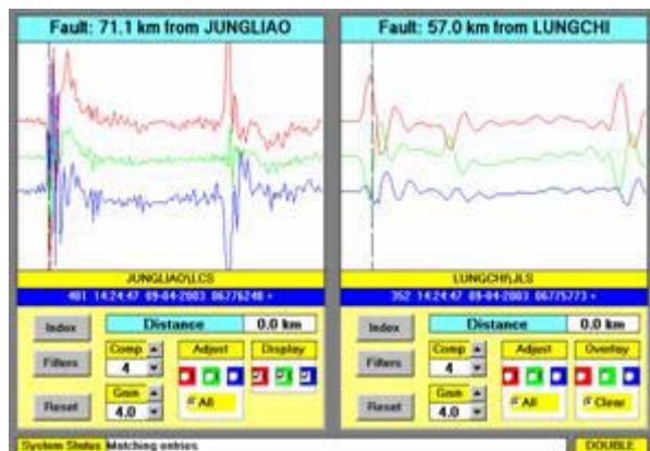
圖二、測距結果（上圖：單端，下圖：雙端）
