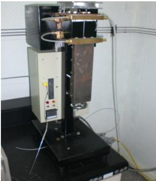
圖1、金屬連接材鉻毒化測試設備實體圖
