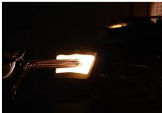
圖1及圖2導火筒之大氣電漿噴鋅情形
