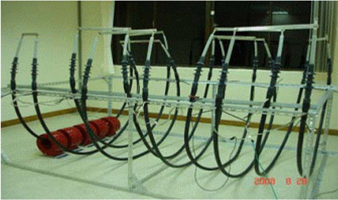
圖1、加速老化壽命試驗架構
