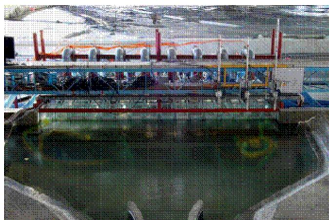
圖2、前池表面流場可視化-拋置彩色浮球長時間曝光
