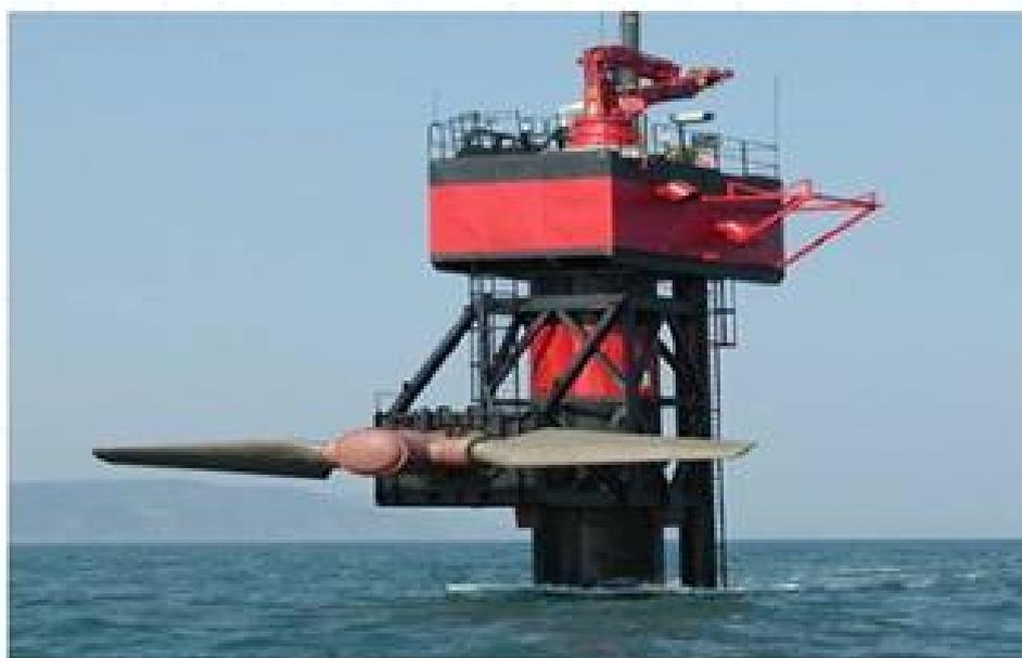
圖1、Seaflo海流渦輪機設備（Source:MCT）
