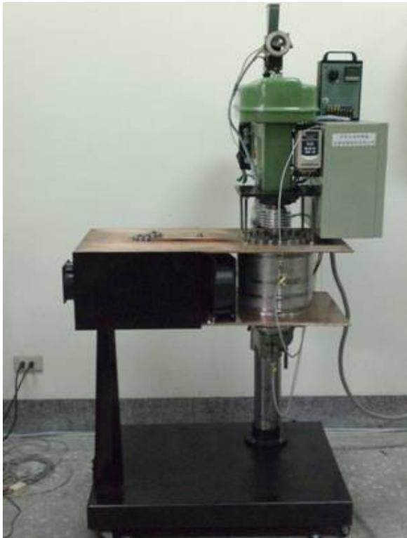
圖1、3.5kg量產型氣氛熔煉爐實體圖
