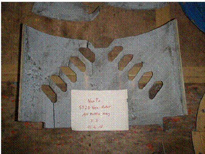
圖1、Air Baffle Ring的破裂情形
