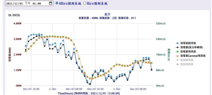
圖 3 金沙風場 6/48 小時風力發電預測
