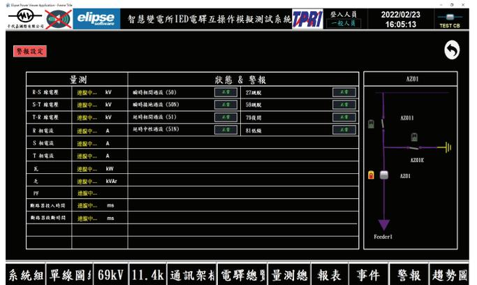
圖 7 IEC 61850 SCADA/HMI 監控系統電驛狀態
