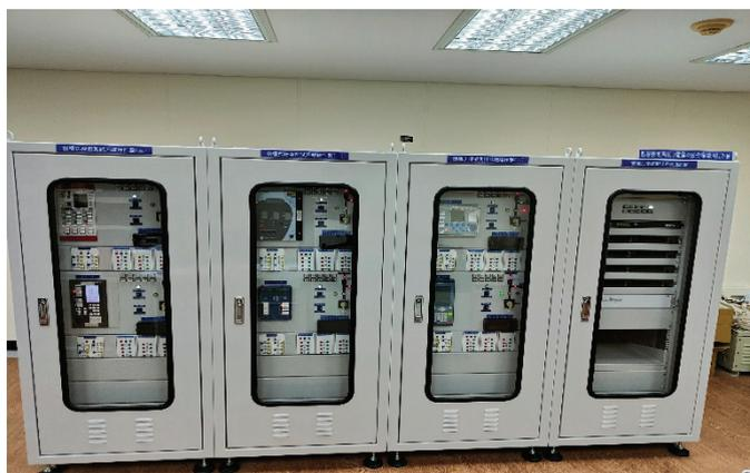
圖 2 IED 模擬測試系統盤
