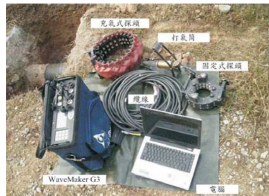
圖 1 導波檢測設備
