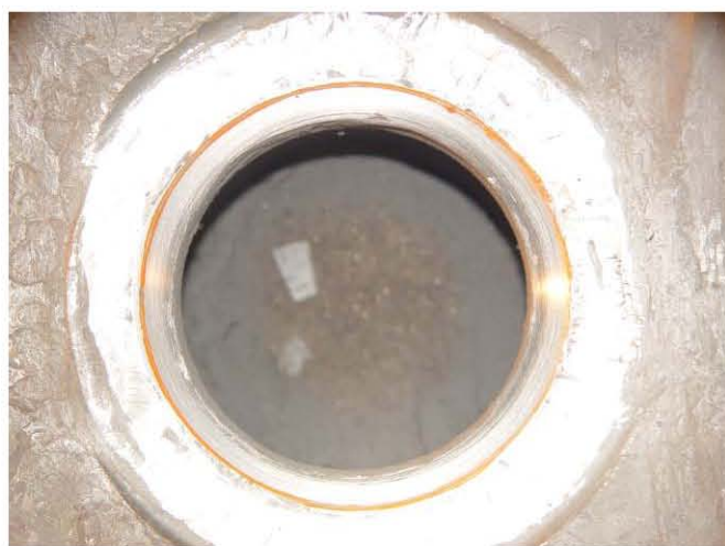
圖3 經密合測試後之閥座汽封環區
