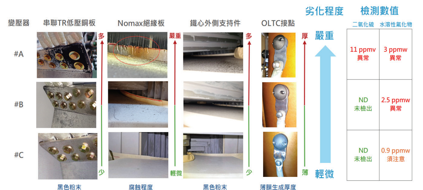
圖 1 內檢設備狀況與實驗室數值對照圖
