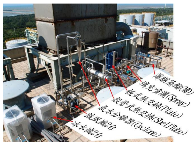
圖1 閃化蒸汽水份回收試驗設備
