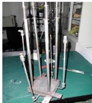
圖 2 SOFC 三層電池堆
