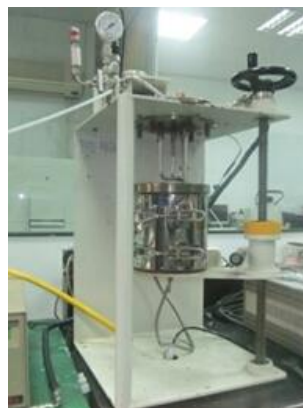
圖1 中十機汽機高壓段葉片腐蝕情形 圖2 高溫高壓反應器模擬腐蝕環境(左)吊掛試片(右)
