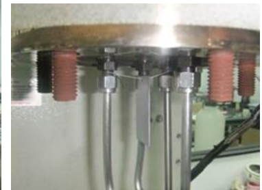
圖1 中十機汽機高壓段葉片腐蝕情形 圖2 高溫高壓反應器模擬腐蝕環境(左)吊掛試片(右)
