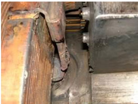
圖1 勵磁迴路J導體 (J-STRAP) 斷裂
