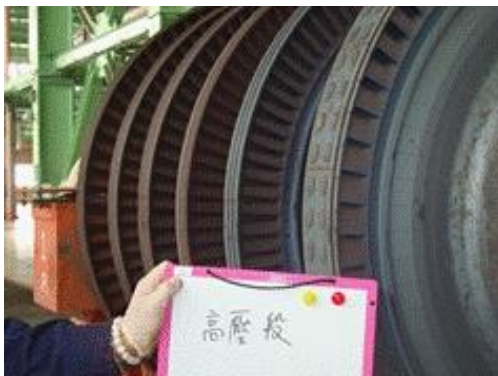
圖1 中十機汽機高壓段葉片腐蝕情形 圖2 高溫高壓反應器模擬腐蝕環境(左)吊掛試片(右)
