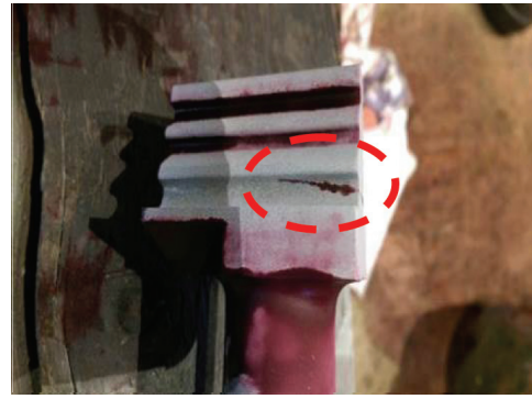
圖 1 本次汽機第 13 級動葉片破裂位置
