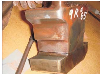
圖 1 1 號機 LP-B 第 9 級#85 葉片之破裂外觀
