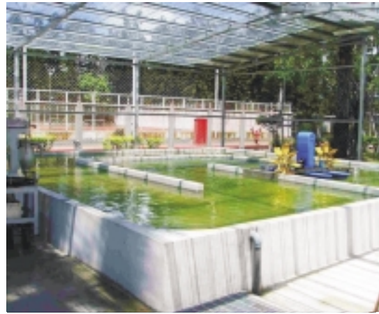
圖 1 28 噸立體光合反應器
