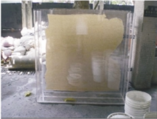
圖 2 水中澆置試驗大型試驗模
