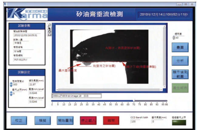
圖 3 矽油膏垂流影像經 LED 平行光產生剪影
