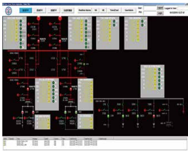
圖2 新社先導型IEC 61850變電所SCADA/HMI
