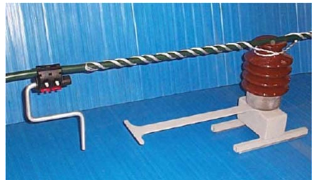
圖 4 BLX 被覆架空線礙子的綁繫線
