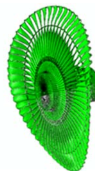
圖 2 單級 L-0 動葉片 AB1L2 模態振型
