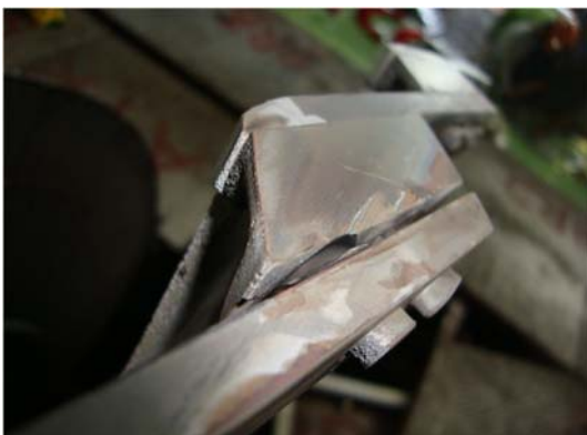
圖 1 中 9 機 L-0 動葉片 Cover Segment 龜裂
