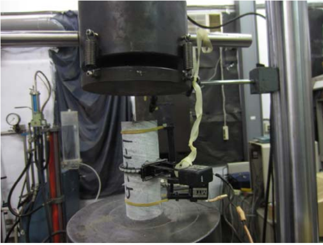
單軸抗壓試體在壓力試驗機上之安裝照片圖 (以試體 G-4-1-R 為例)
