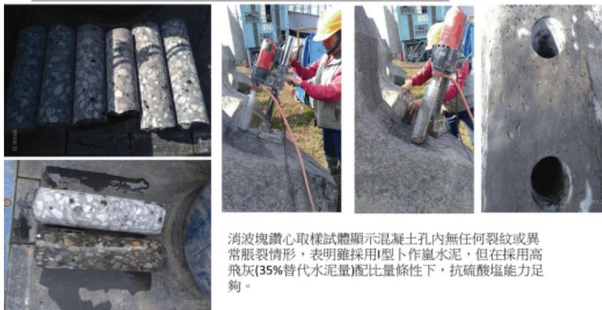
消波塊鑽心取樣試體顯示混凝土內無任何裂紋或異常脹裂情形，表明雖採用I型卜作嵐水泥，但在採用高飛灰(35%替代水泥量)配比量條件下，抗硫酸塩能力足夠。
