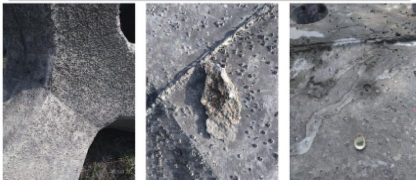
圖 2 高煤灰摻量混凝土製消波塊海域實測情況
