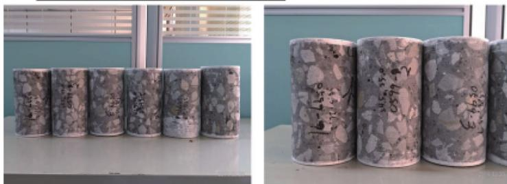
消波塊鑽心試體抗壓測試破裂面大致上均在細粒料膠結材或膠結材與礫石膠結面。鑽心試樣表面無膨脹裂紋現象或混凝土膨脹粒料鬆脫現象，表示抗硫酸塩能力良好。
