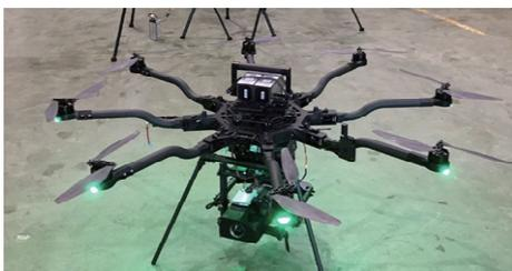
圖 1 八軸型多旋翼無人飛行器
