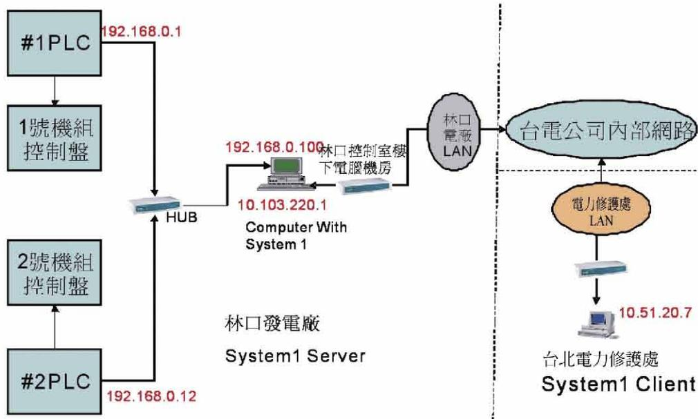
圖1 林口電廠主汽輪發電機組之震動監測系統資料傳輸架構
