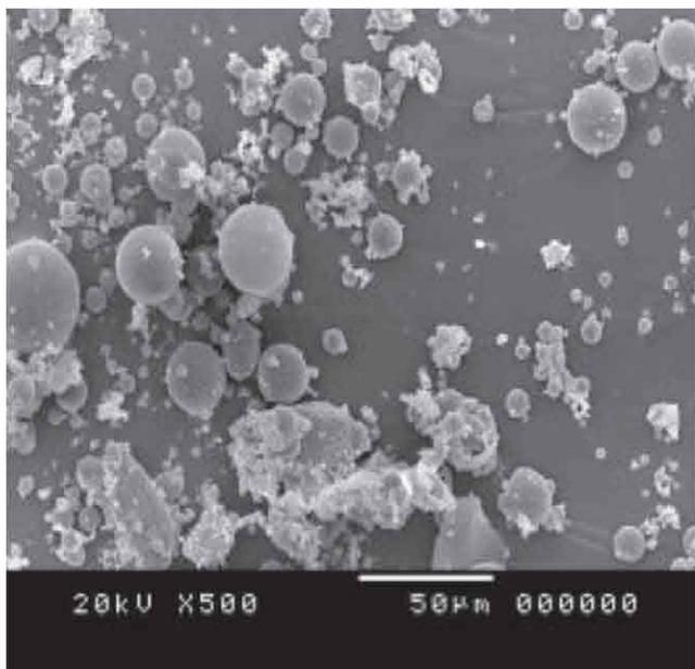
圖1 台中電廠飛灰 SEM 微觀照片 (×500倍)
