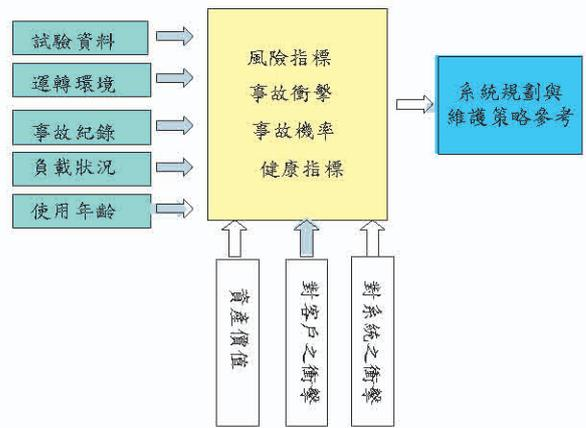
圖 2 變壓器風險評估模型
