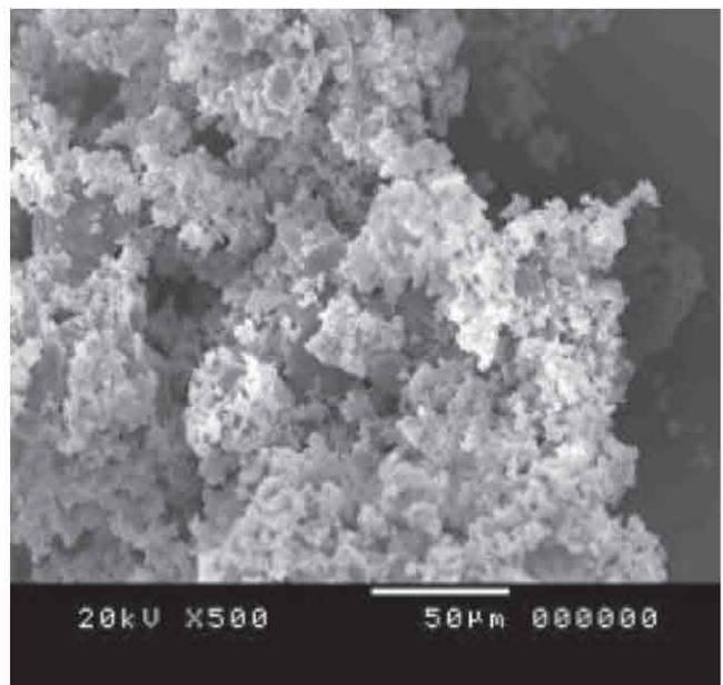
圖2 協和電廠集塵灰 SEM 微觀照片 (×500倍)
