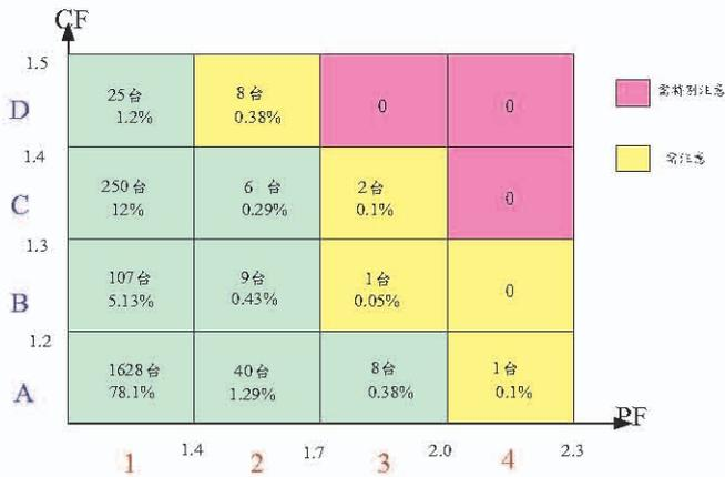
圖 1 變壓器風險評估結果
