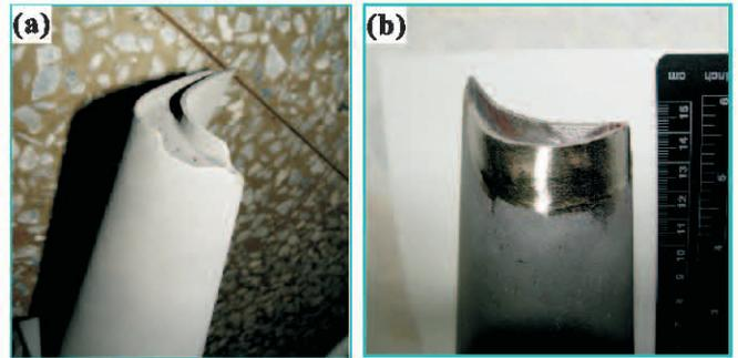
圖 2 GE 氣渦輪機第 1 級動葉片：(a)頂部缺損區，與(b)經同軸雷射粉末披覆處理技術銲修之外觀照片。
