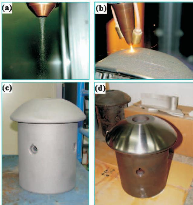
圖 1 同軸送粉噴嘴之：(a)粉末流束外觀；(b)進行 GE 汽機控制閥盤舊品之再生銲修過程；(c)閥盤舊品沖蝕區；及(d)經再生後之閥盤外觀照片。
