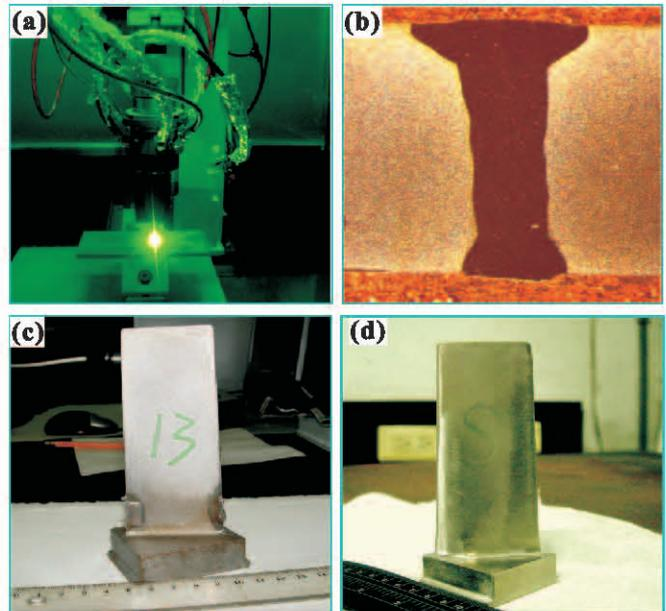
圖 3 光纖雷射：(a)進行同軸雷射披覆處理之外觀；(b)銲接西門子第 1 級動葉片之光學金相；及(c)與(d)同軸送粉披覆處理銲修 GE 空壓段損傷靜葉片後與研磨後之照片。
