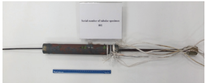
圖 3 爐管試樣安裝熱電偶及應變感測裝置
