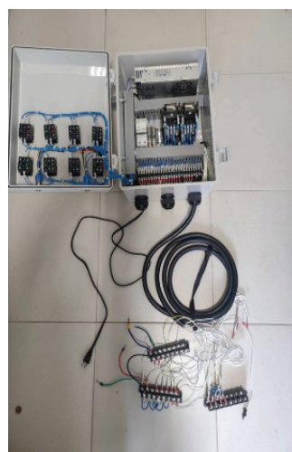
圖4 測試治具內部接線圖
