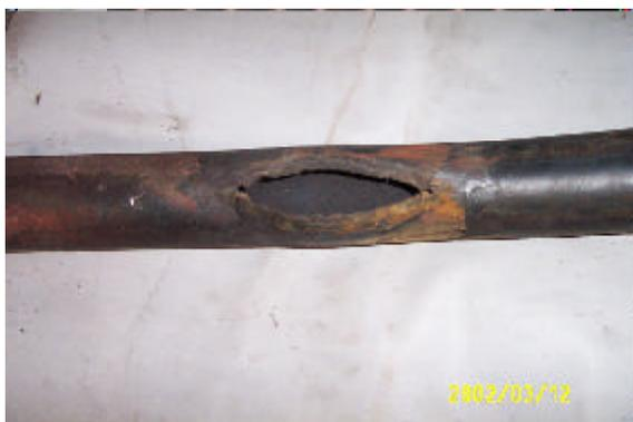
圖一 爐管爆破破口 (電廠提供)
