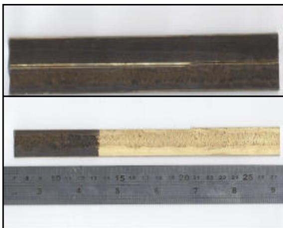
照片1 協和 #1機冷凝管破管表面清洗氧化皮膜前後比對
