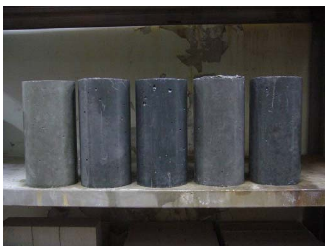
圖1、混凝土圓柱試體外觀
