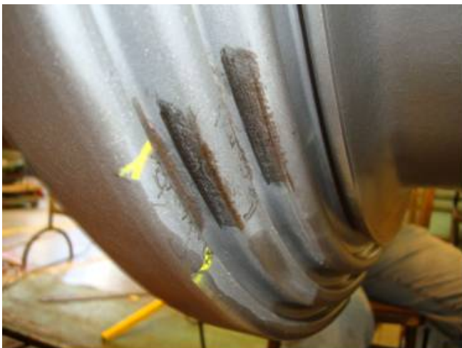
圖1 汽機高壓段#1級動葉片葉根槽研磨情形
