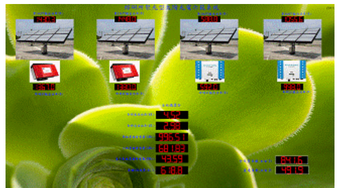
圖2、10 kWp HCPV示範系統即時監控系統
