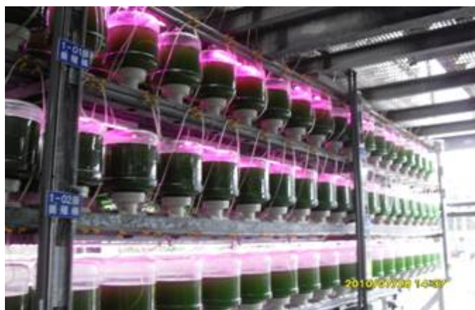
圖1、28噸光合反應器養殖螺旋藻
