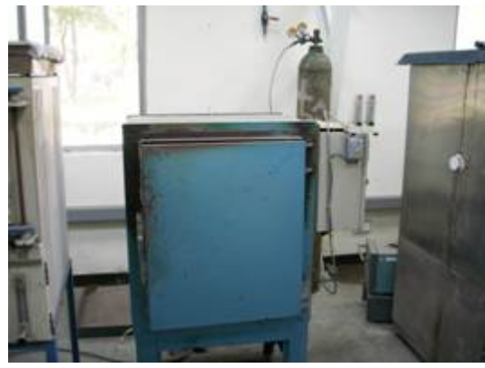
圖2、100%CO 2 情況下大型試樣之CO 2 吸附測試爐
