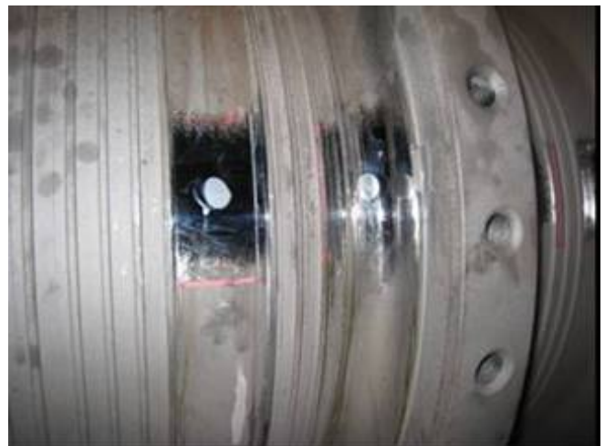
圖2 汽機高壓轉子IP前汽封環附近取樣照片
