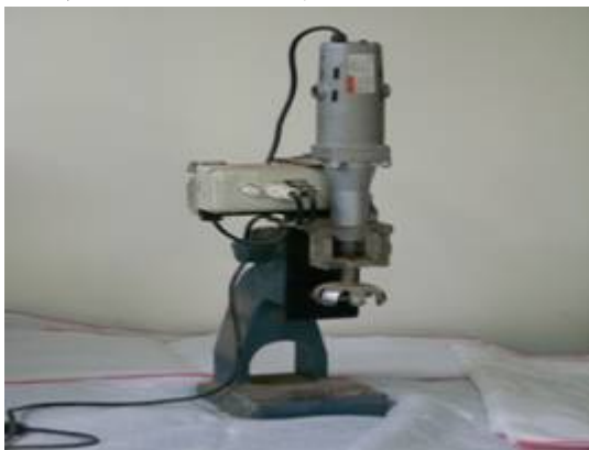
圖1、快速(最高4000轉/分)均質乳化機；CaCO 3 之細化使用
