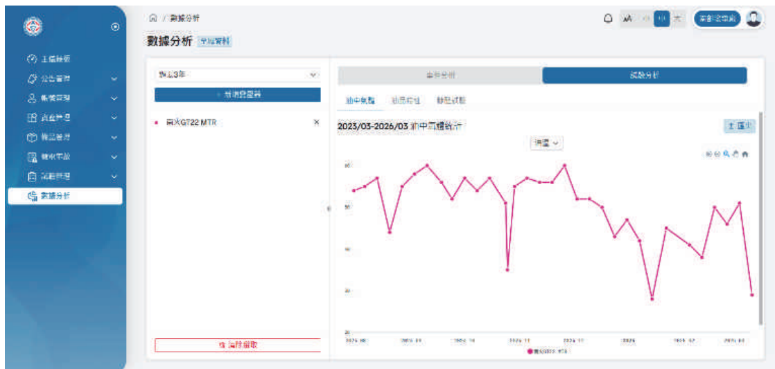
圖 3 變壓器油中氣體數值歷史趨勢分析
