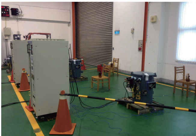
配電變壓器溫升試驗
