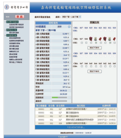
圖 6 個別障礙燈監控頁面
