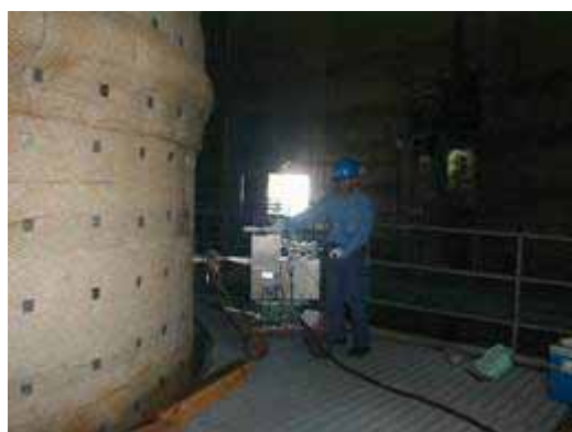
圖1、採用ASTM D6784-02方法實際於台中電廠煙囪位置進行煙氣採取的示意圖。
