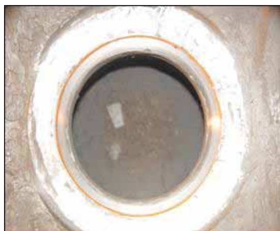
圖 2 GV 控制閥座銲修加工後經密合測試之汽封環照片。
