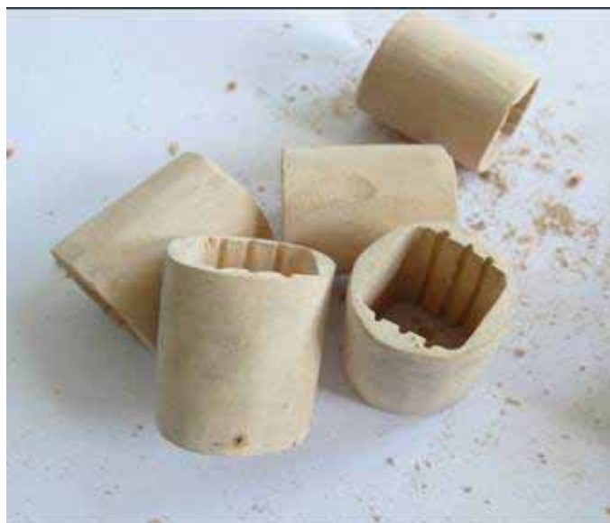
圖1、拉西環狀的充填濾料
