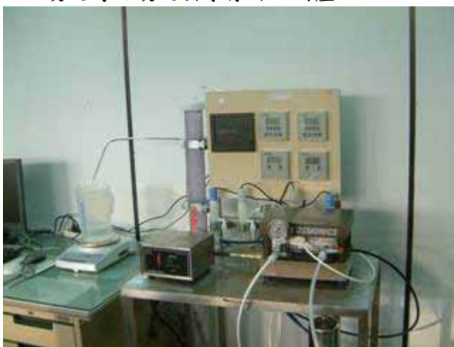
圖1、奈米薄膜再濃縮FGD廢水之試驗設備
