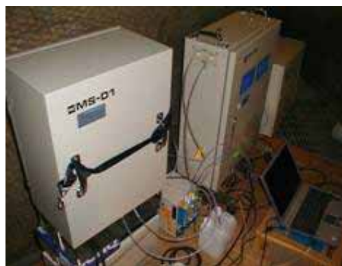
圖2、連續式總汞和元素態汞同時分析偵測儀裝於台中電廠煙囪位置，進行連續監測的示意圖。
