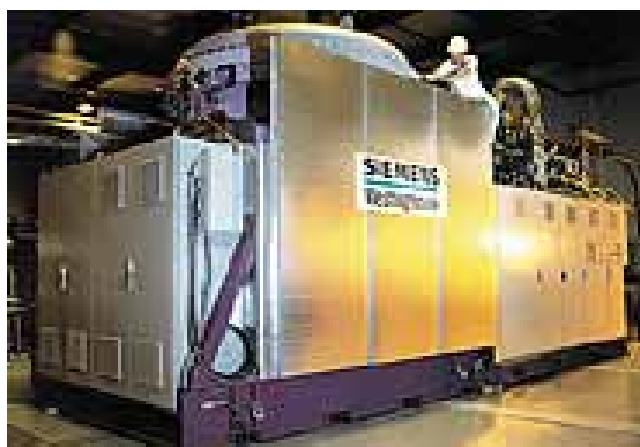
圖1、FCE公司250kW (MCFC) 與60kW MT混合型示範系統 圖2、世界上第一台220kW (SOFC) /MT混合型示範系統
