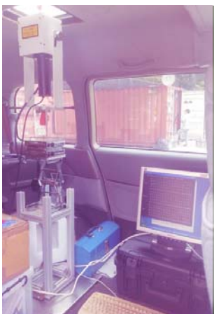
圖 5 Lidar 量測設備
