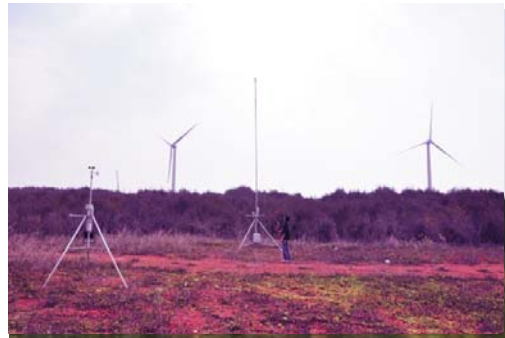
圖 4 3m 及 10m 移動式測風塔
