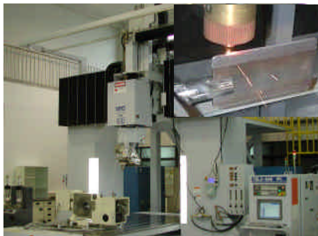
氣渦輪機葉片再生損傷修補製程
