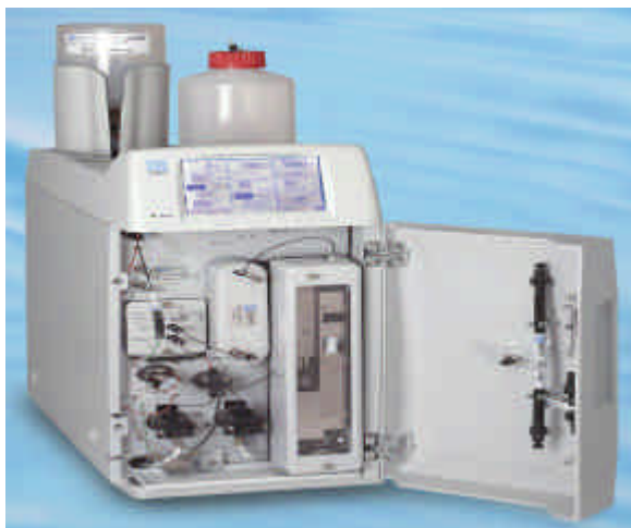
圖一：離子層析儀（ICS-2000）系統組成
