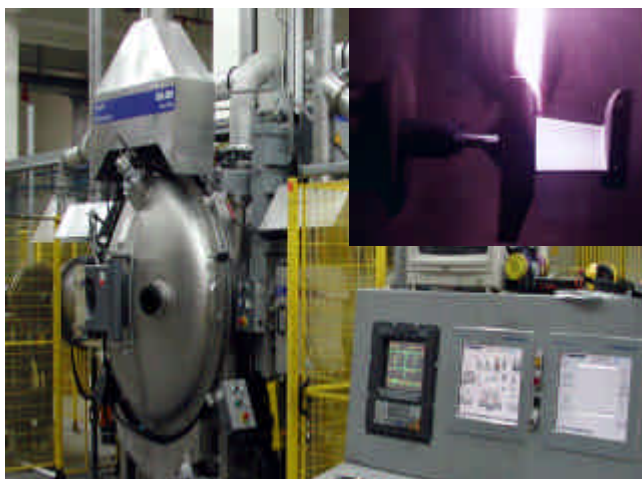
氣渦輪機葉片再生塗層重建製程
