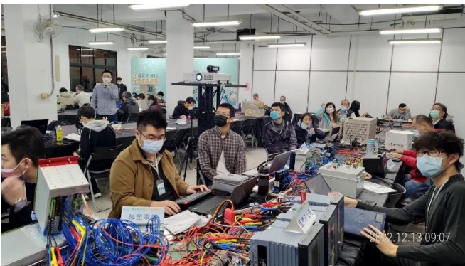
台電公司 IEC 61850 互操作性試驗 資料來源：綜研所資通室
