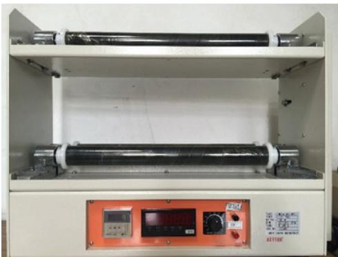
圖 1 濕式滾動造粒設備
