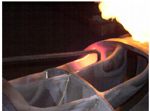
2、轉輪翼片表面火焰加熱耐磨合金被覆
