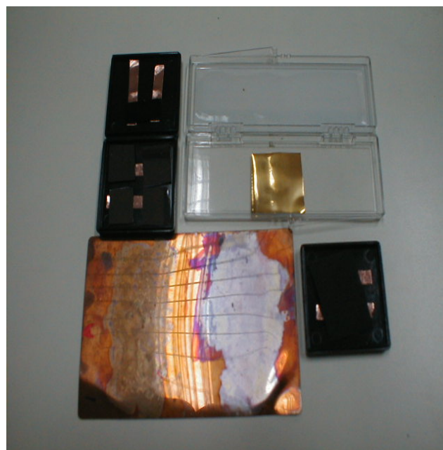
圖1、奈米碳管、金、銅和碳布等電極材質的表面加工處理圖示。
