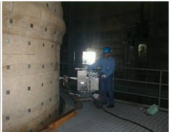
圖1、台中電廠7號機組煙氣中汞物種連續分析。圖2、利用OH方法進行台中電廠7號機組煙氣汞物種的採樣。
