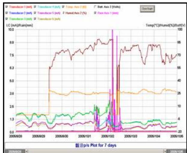
圖2、強烈颱風過境時各類礙子洩漏電流走勢
