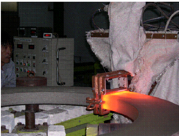
圖1、導翼座襯圈表面感應加熱耐磨合金被覆
