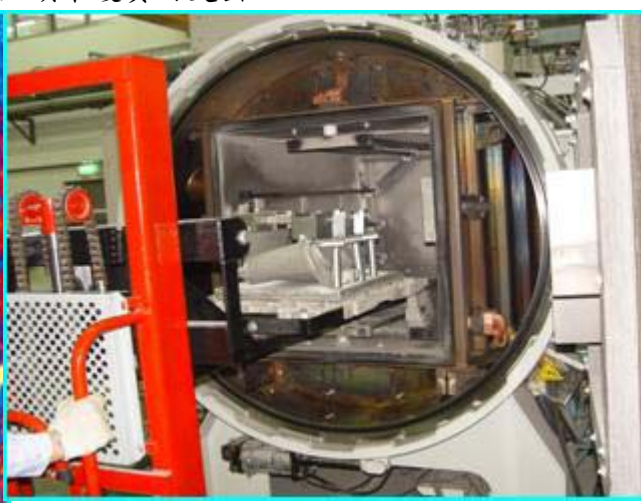
圖2、GE第2級靜葉進行真空硬銲之照片。
