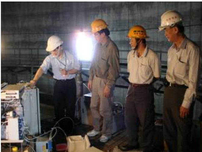
圖1、台中電廠7號機組煙氣中汞物種連續分析。圖2、利用OH方法進行台中電廠7號機組煙氣汞物種的採樣。
