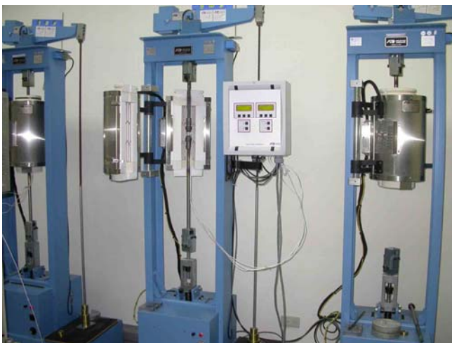
圖1、潛變試驗機及試片吊掛情形
