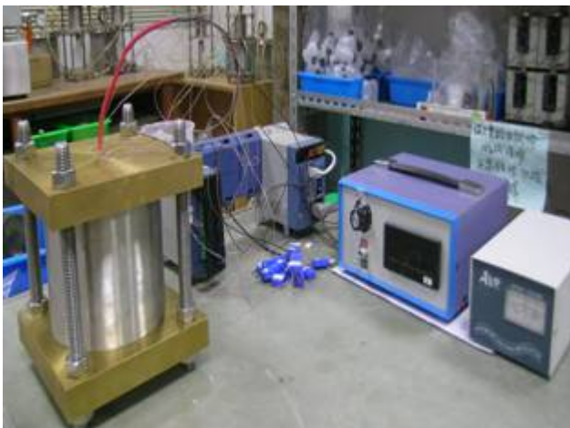
圖1、膨潤土暫態溫度分佈量測設備
