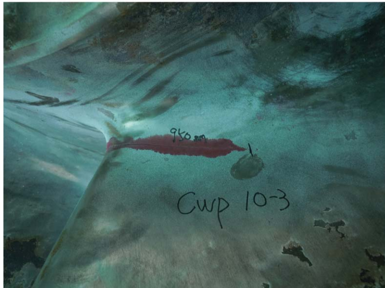
圖 1 循環水泵舊葉輪龜裂之宏觀照片
