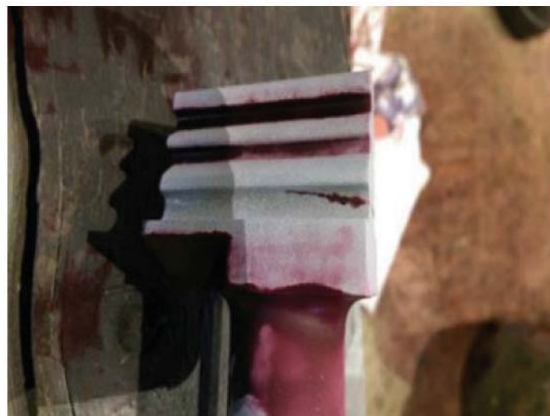
圖 1 本次汽機第 13 級動葉片破裂位置
