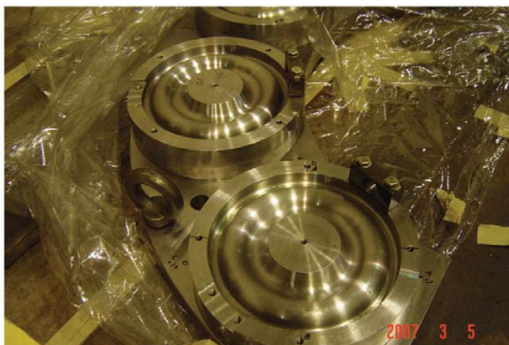
圖 1 明潭發電廠水力機組推力軸承底部支撐環
