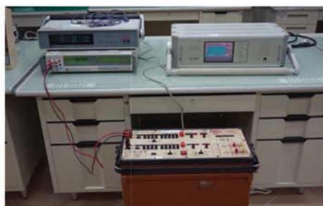
電驛試驗器校正 (Doble F2253)
