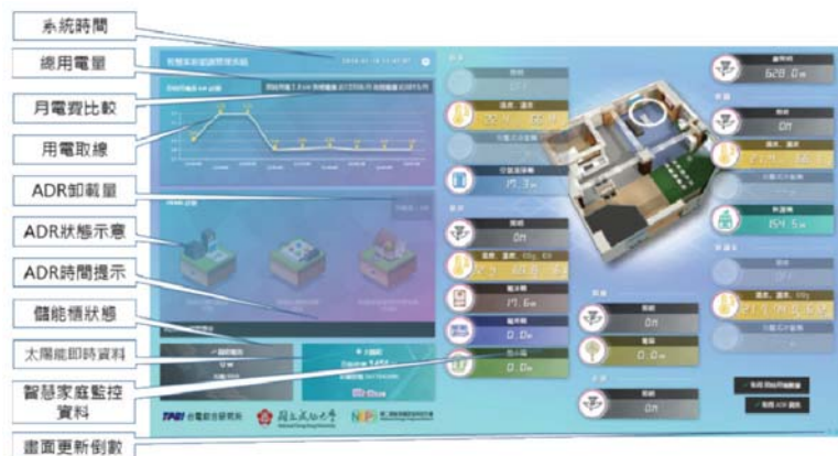
圖 3 展示室智慧型電表結合家庭能源管理系統數位電視儀表板
