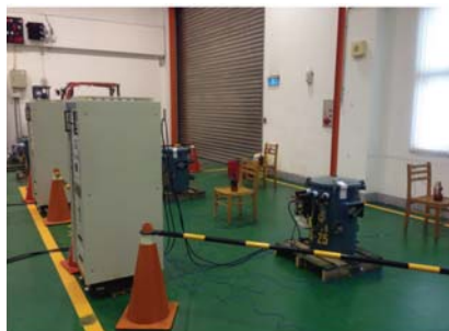
配電變壓器溫升試驗
