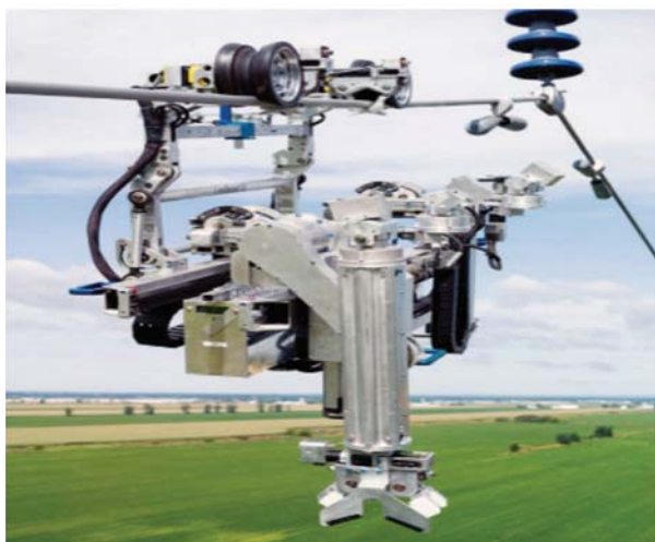
圖 1 輸電線路活線作業機器人
