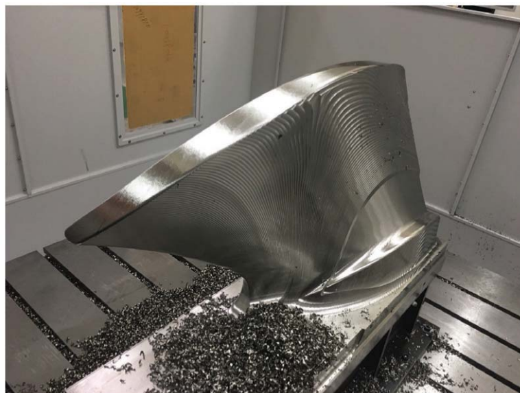
圖 2 CWP 葉輪 CNC 加工照片
