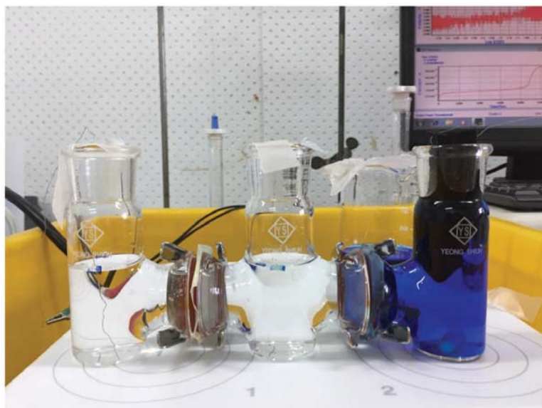
圖 1 電解法製備正負極電解液
