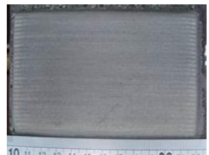
圖1. 鐸道凝固熱裂之SEM照片 圖 2. Deloro50雷射披覆鐸道金相 圖3. Deloro50雷射披覆鐸道外觀
