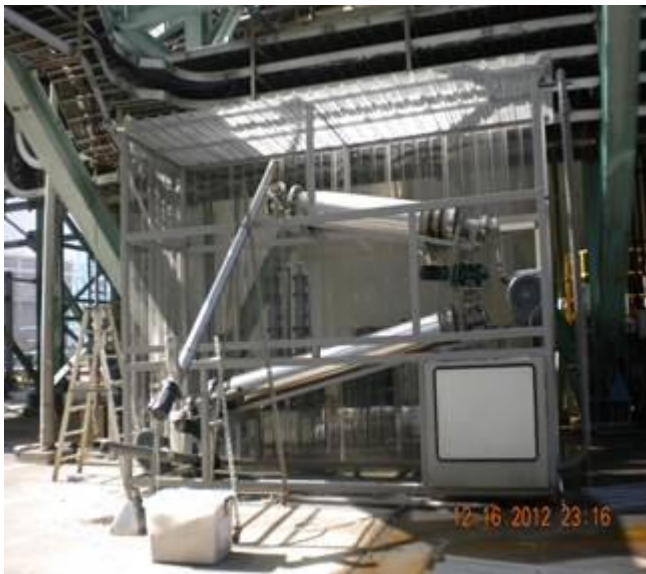
圖1、設置於燃煤電廠之焙燒爐
