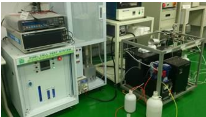
氫純化與固態氧化物燃料電池協同試驗現場配置
