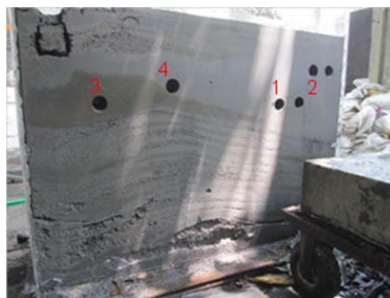
圖2、高底灰含量全煤灰CLSM 澆置之試體
