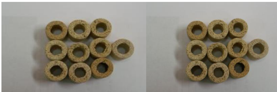
圖 1、煤灰多孔陶瓷抗西環燒結完成樣品
