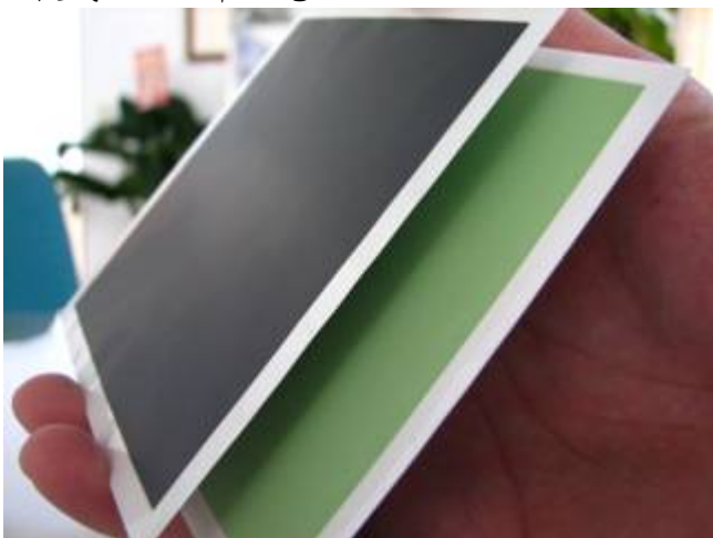
圖1. 10 \times 10 \text{ cm}^2 高溫電解質支撐SOFC單元電池
