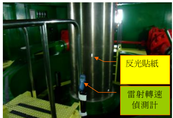
圖 1、量測工作進行前在大觀二廠轉速計設置狀況
