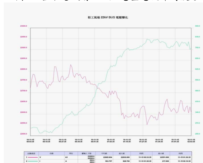
圖2、彰工風場匯流排電壓變動計算
