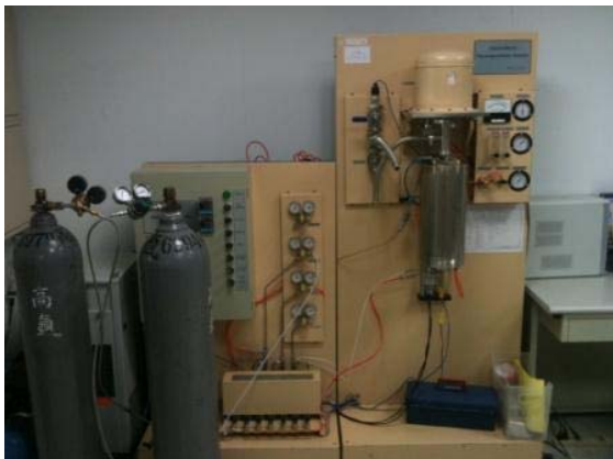
圖1、高溫氧化試驗設備實體外型圖
